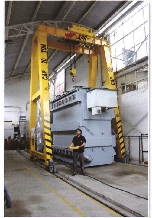
FYR Ingenieros Ltda. - Bogotá Grúa Pórtico - Birriel - 20.000Kg
